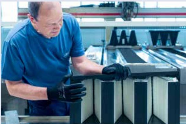
Durch die Plissierung ergibt sich eine vergleichsweise große Filterfläche bei hoher Stabilität, was den Kompaktfiltern besondere Anwendungsgebiete erschließt. Insbesondere wenn es um hohe Nennvolumenströme, große Stabilität und hohe Abscheideleistung geht, kommt diese Bauform zum Einsatz, beispielsweise in Gasturbinen, Off-Shore-Anlagen oder zum Schutz hochwertiger Anwendungen in der Reinraumtechnik.
